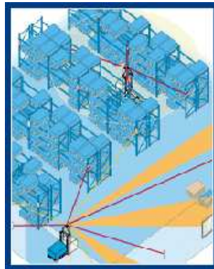
Figur 3. Laserscannern mäter till olika reflektorer i sin omgivning.
